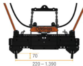
Rasengitter Backen kurz: Zum Versetzen von 1, 2 u. wahlweise 4 Rasengittersteinen
