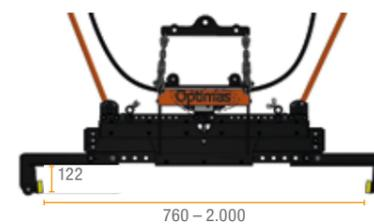
Verlängerte Backen: Zum Versetzen von z. B. Blockstufen
